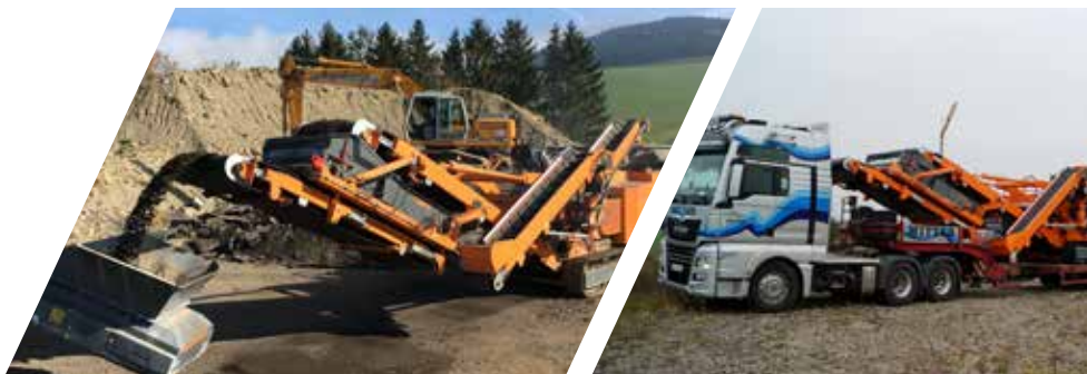
Seitenband, Breite: 650 mm hydraulisch klappbar Abwurfhöhe: ~ 2,4 m
